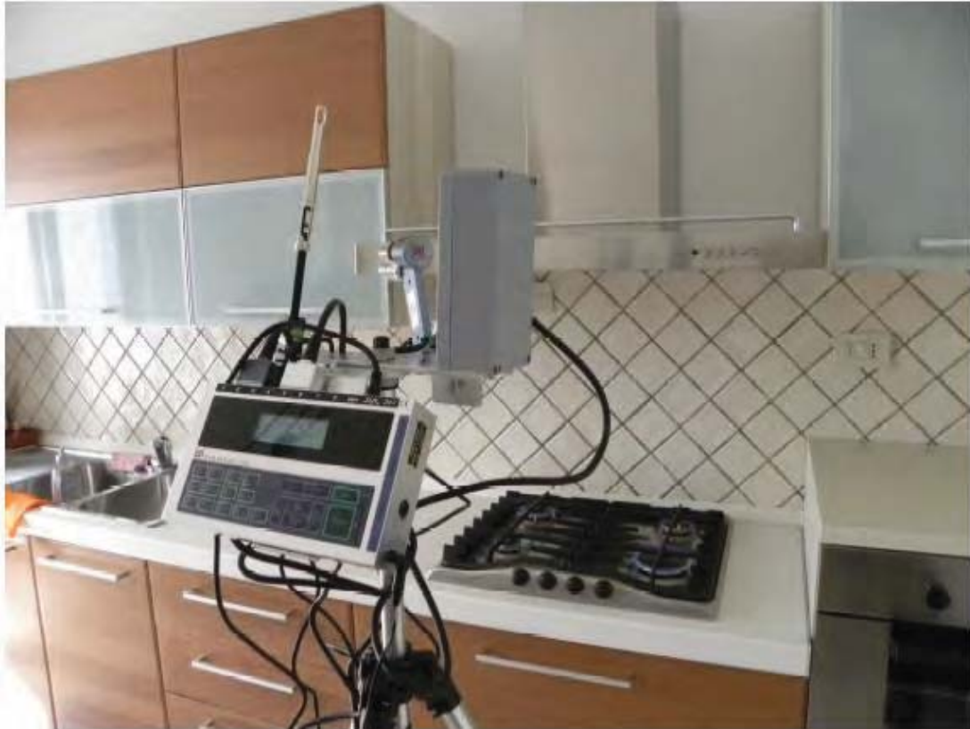
Fig. I.1-14: Centralina di rilevazione e registrazione
